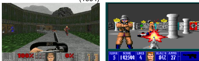
Рисунок 9 – (слева) Doom и (справа) Wolfenstein 3D. Пример применения техники “billboarding”
